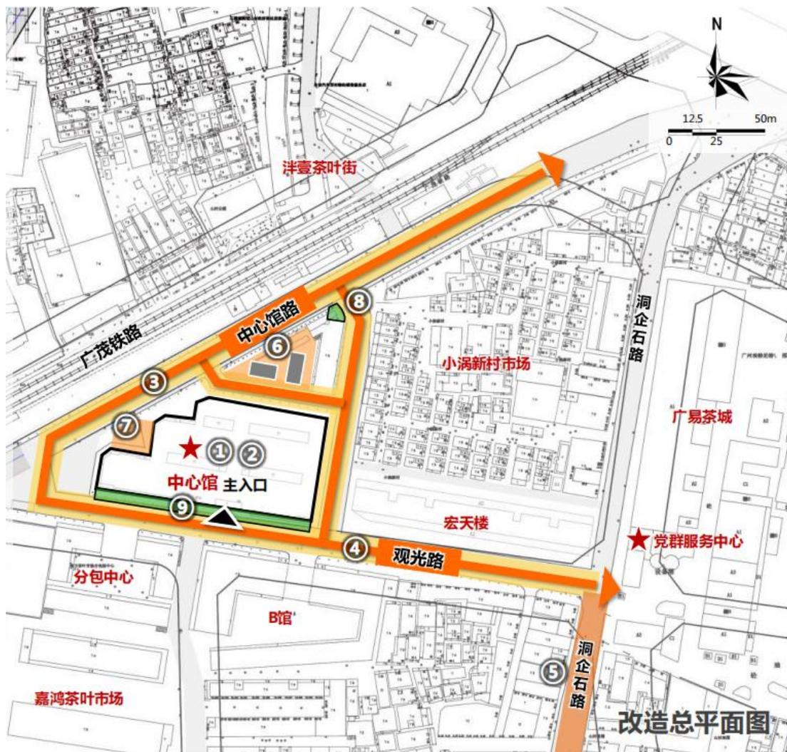
图 5-21 交通提升改造平面图
