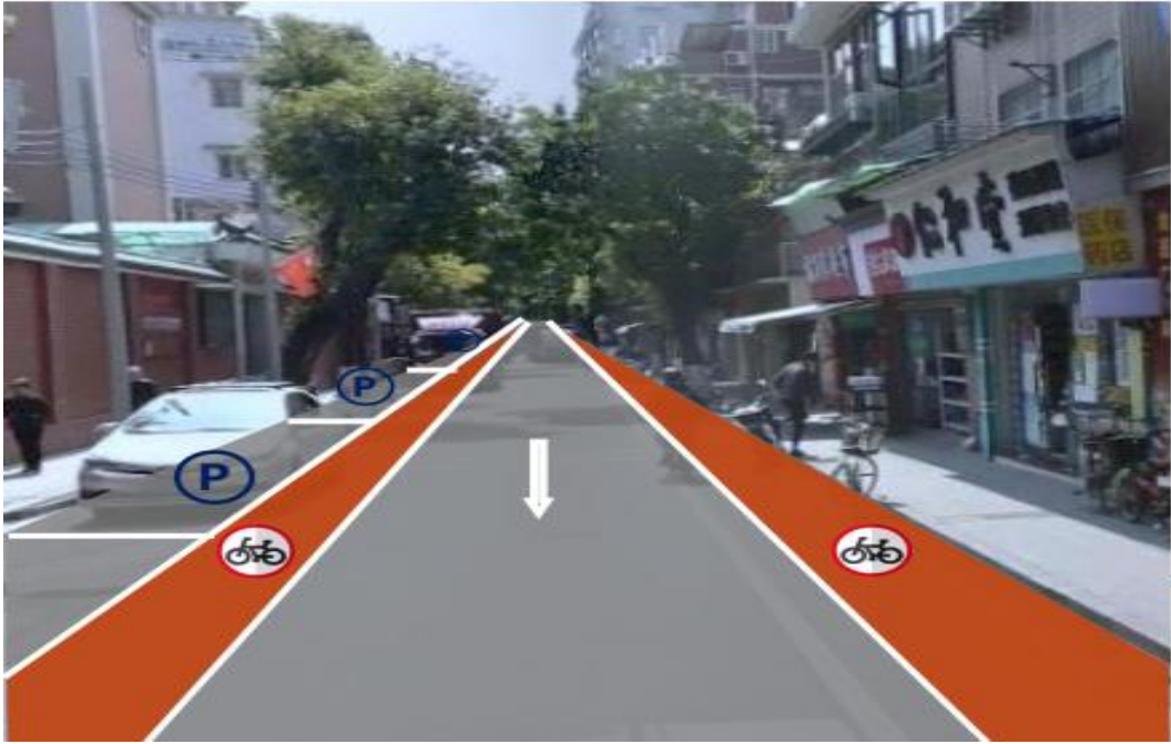
图 5-2-3 车行道改造效果示意图
