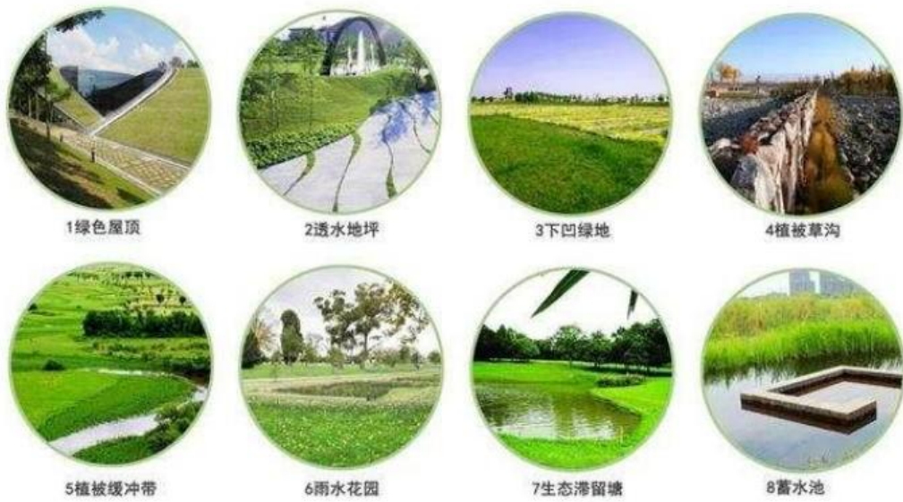
图 11.6-1 绿色雨水基础设施
