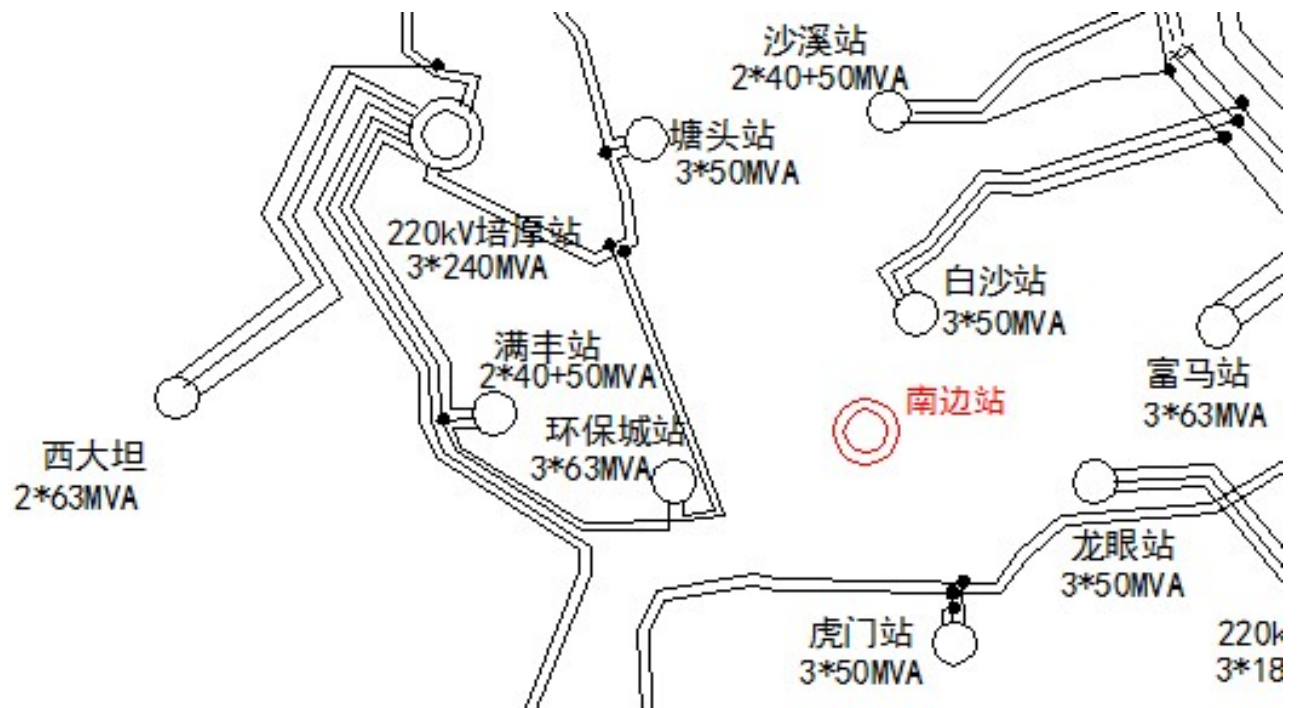
图 2.7-2 停电前本工程近区 110kV 电网接线图
