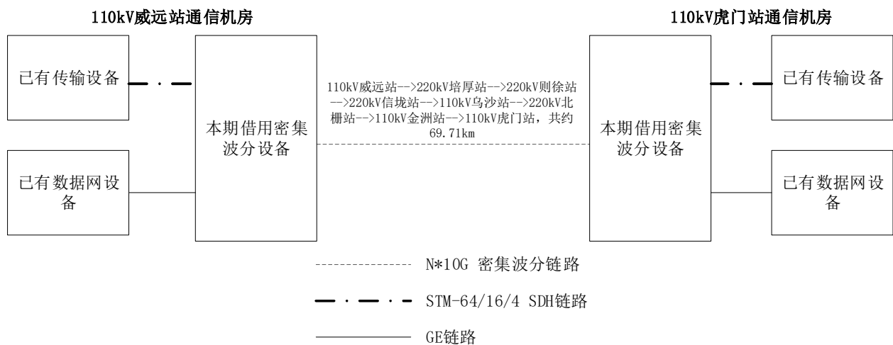
图 4.5.3-2 北威甲线 12 芯 ADSS 光缆波分复用恢复方案示意图
