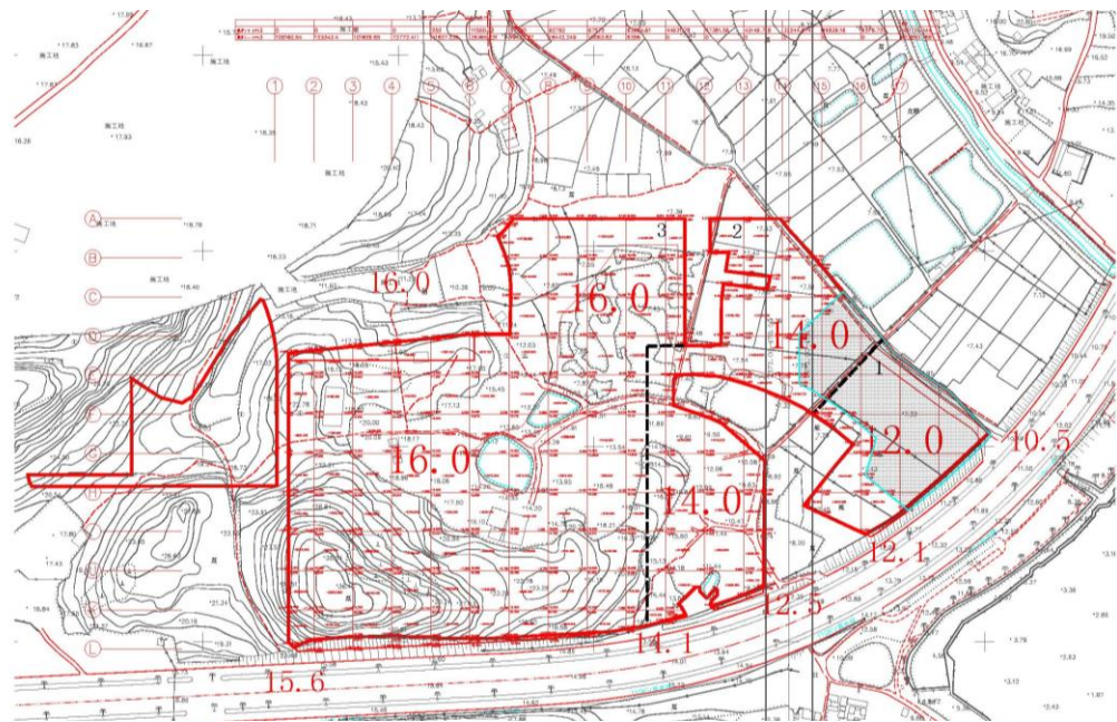
图 5.2-11 项目场地土方量计算图表
