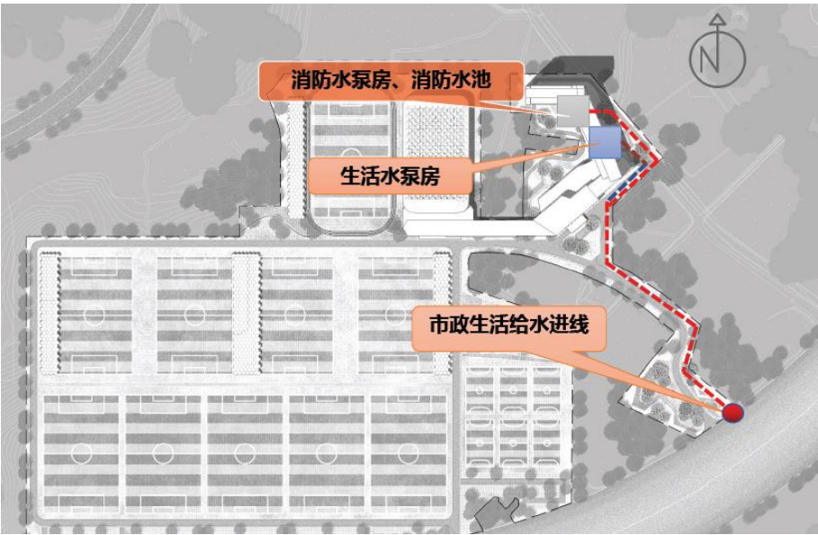
图 5.5-1 给水管线接驳示意图
