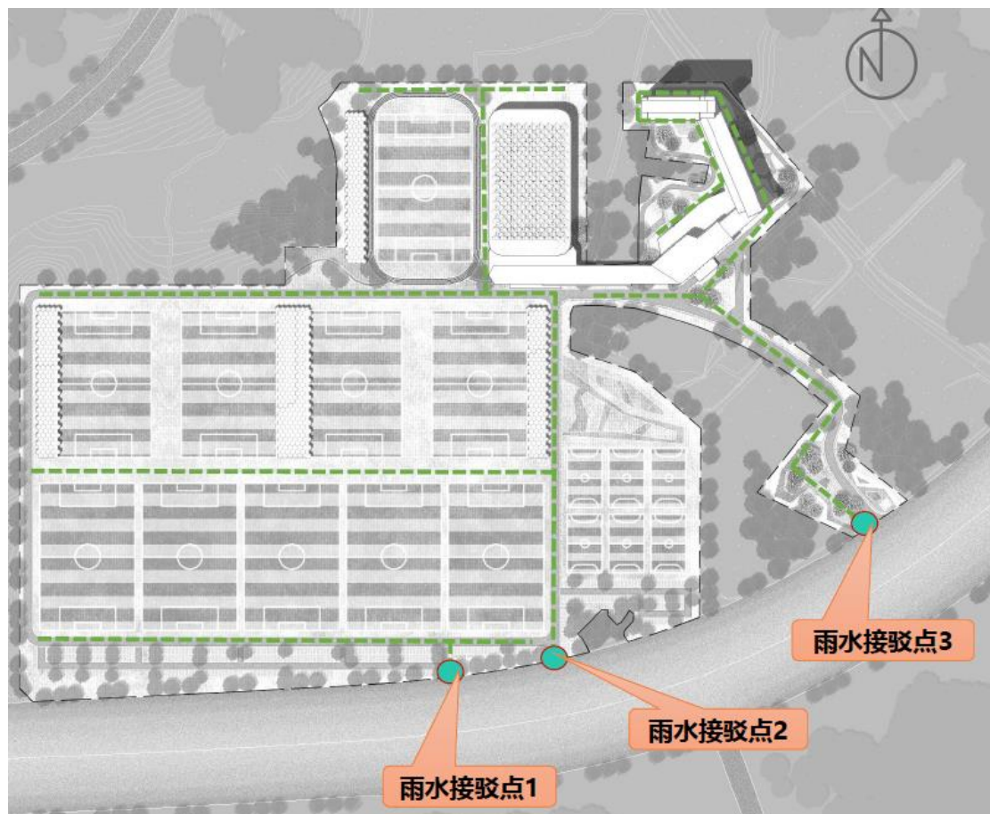
图 5.5-3 雨水管线接驳示意图
