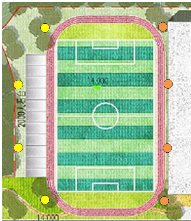
图 5.10-9 参考灯杆布置平面图
