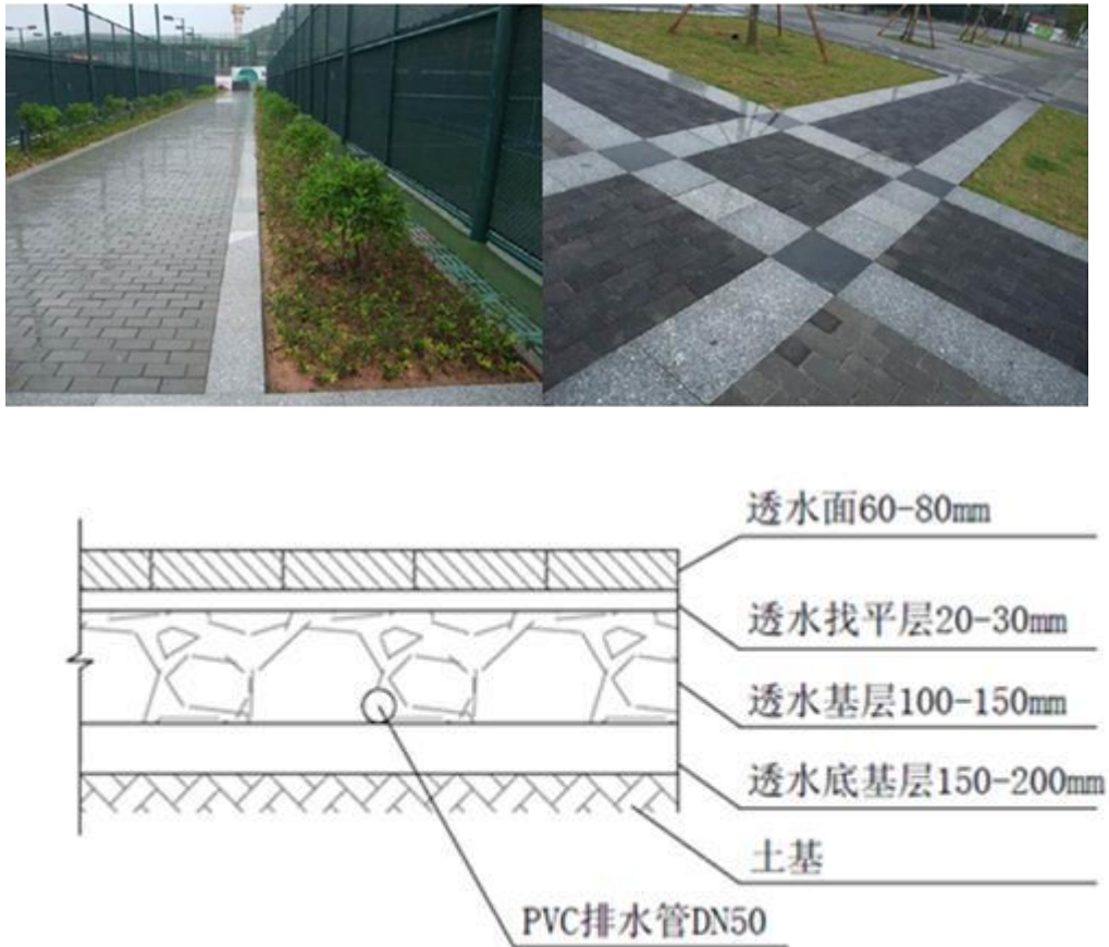
图 6.2.4-3 透水砖铺装典型结构示意图
